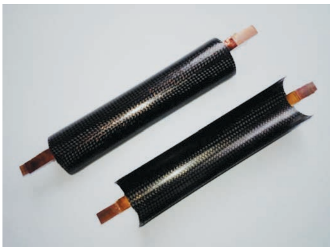
рисунок 7. Элементы самораскрывающейся петли с памятью формы и интегрированным в композит плёночным нагревателем
