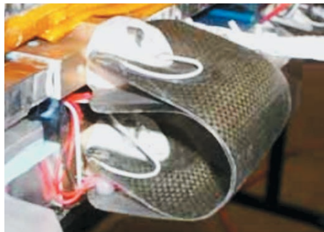
рисунок 6. Самораскрывающаяся петля из композита с памятью формы фирмы CTD
