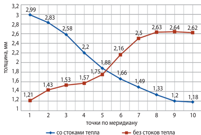
рисунок 9. Распределение толщины полусферы по меридиану (1 – фланец, 10 – центр)
