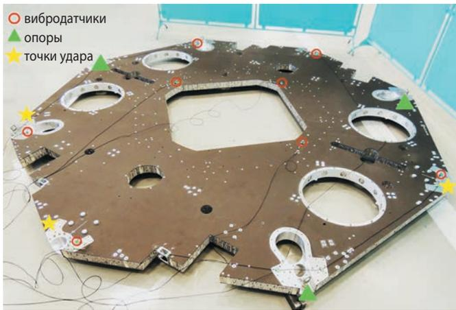
**рисунок 2.** Схема испытания посадочной платформы
