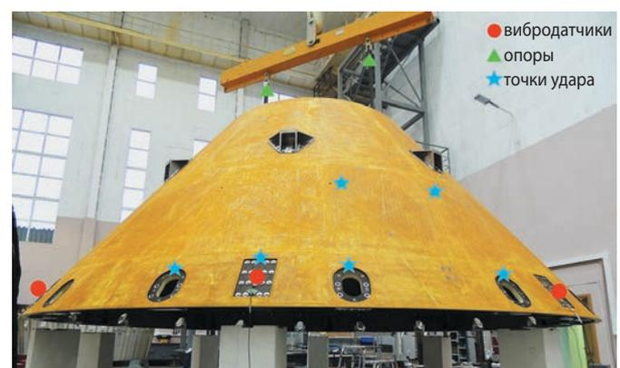
**рисунок 6.** Схема испытания заднего кожуха
