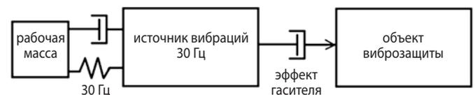
рисунок 4. Схема работы ВГ
