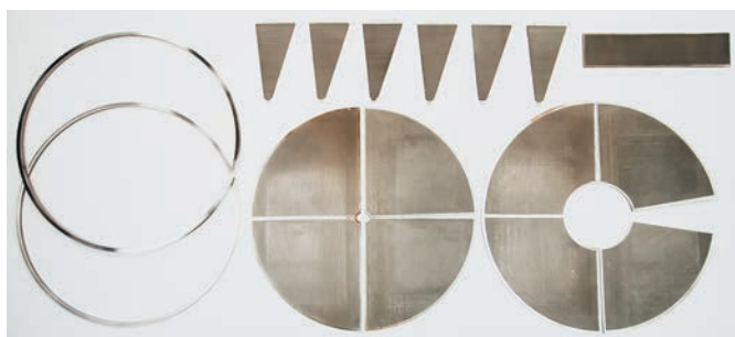
рисунок 2. Детали ФУ из КПСМ (диаметр 340 мм)
