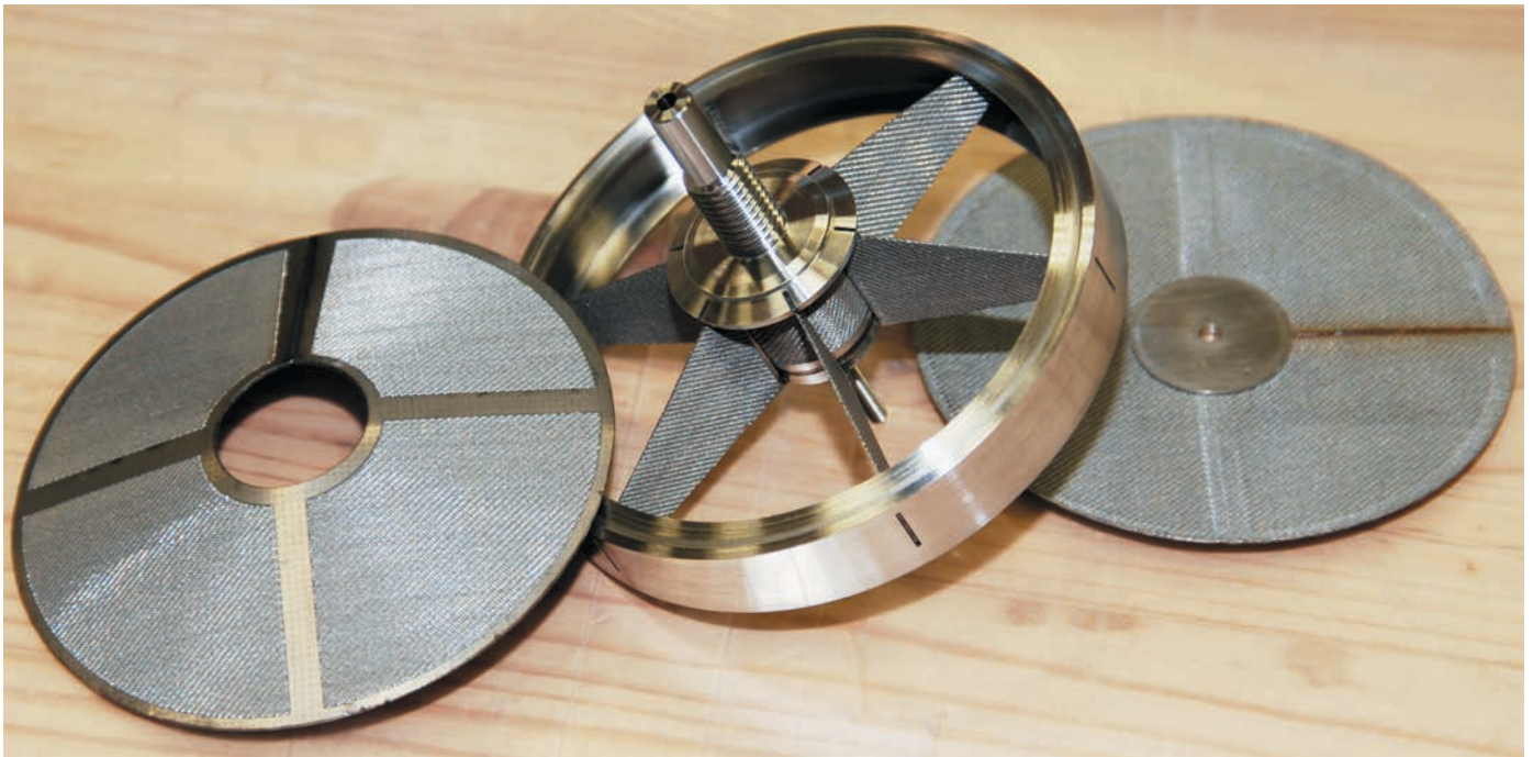
рисунок 3. Элементы макетного типизированного ФУ ВБУ КТ
