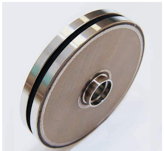
рисунок 5. ФЭ ТФ из КПСМ в сборе (комплектующие детали из КПСМ приведены на рисунке 1)
