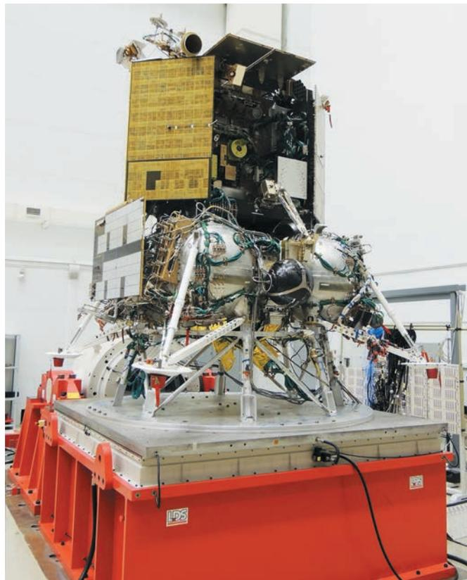
**рисунок 2.** КА «ЛУНА-ГЛОБ» на вибростенде
