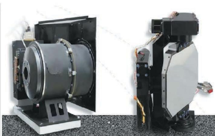
**рисунок 1.** 15 см УФ-телескоп LUT с системой наведения на основе плоского зеркала. Установлен на посадочном модуле миссии CHANG'E 3
