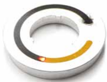
рисунок 5. Горение МЗС в дуговом канале (элементы герметизации демонтированы)
