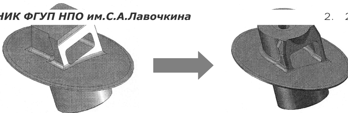
Рис. 5. Изменение конструкции верхней силовой опоры
