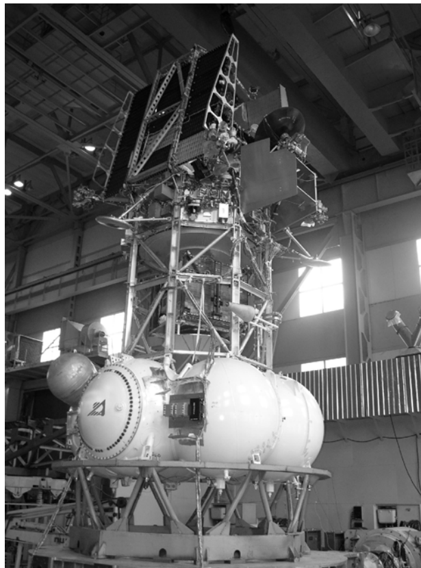
Космический комплекс "Фобос-Грунт" на вибро-динамических испытаниях
