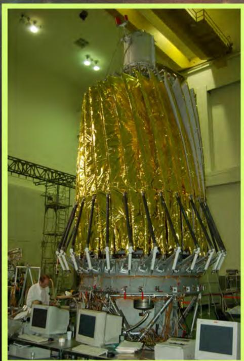
Испытания на раскрытие космического радиотелескопа
