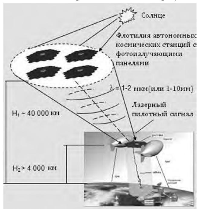
Рисунок 1. Схема космической солнечной электростанции и автономных спутников
