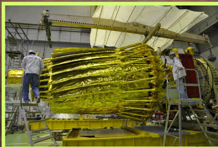
Изделие переустановлено из транспортного контейнера в поворотный стенд
