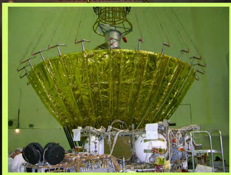
Испытания на раскрытие космического радиотелескопа
