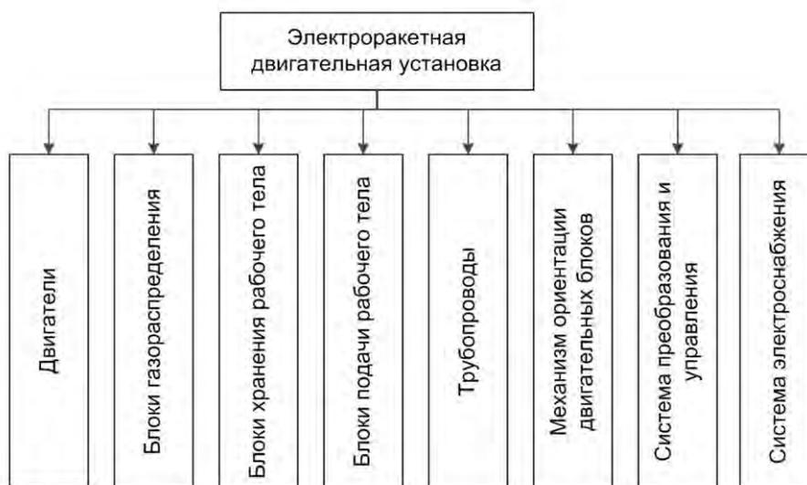
Рисунок 2. Типовая структура ЭРДУ
