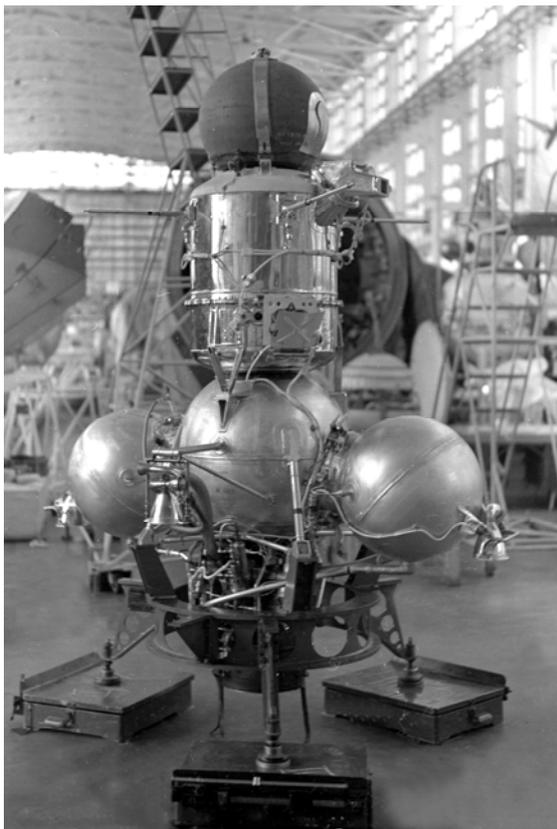
**Возвратная ракета на испытаниях в КИС
