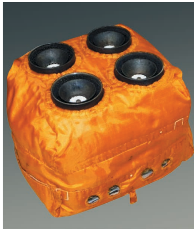
рисунок 3. Блок НА ИПИ в экранно-вакуумной тепловой изоляции
