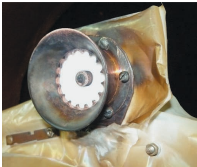
рисунки 5. Разрядный канал макета инжектора блока НА ИПИ
