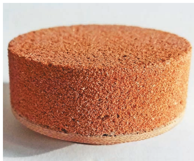
рисунок 1. Внешний вид образцов ТЗП АЭ (а) и ЗК (б)
