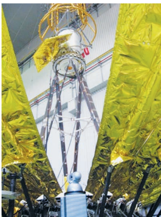
рисунок 3. Прецизионная складная параболическая антенна КРТ (а–е см. по тексту)
