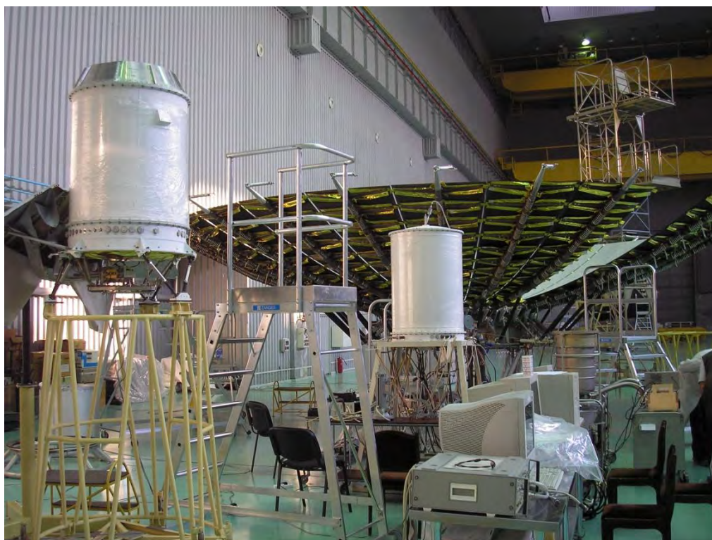
Рисунок 4. Фокальный (слева) и приборный (справа) контейнеры КРТ
