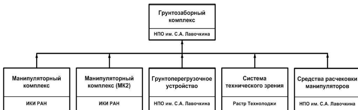
Рисунок 1. Состав грунтозаборного комплекса
