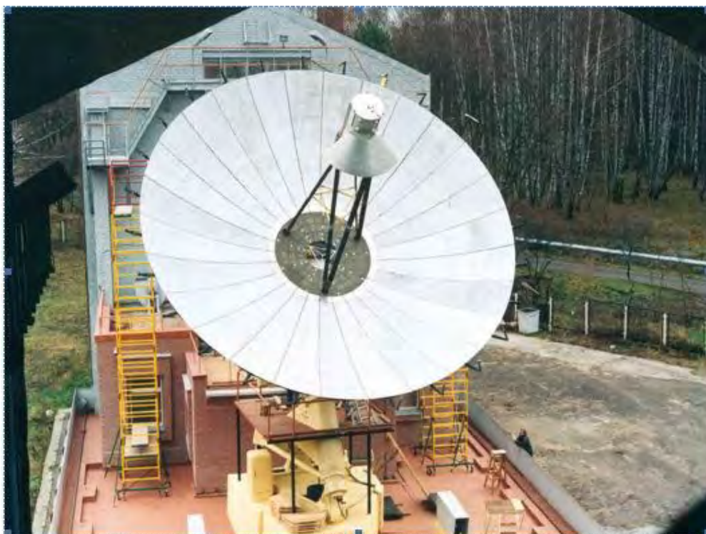
Рисунок 7. Испытания космического радиотелескопа по астрономическим объектам (Пушино, обсерватория Астрокосмического центра ФИАН, весна 2004 г.)
