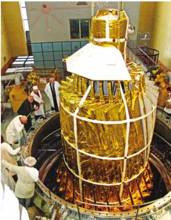
**рисунок 5.** Установка КА «Спектр-Р» в ВК 600/300
