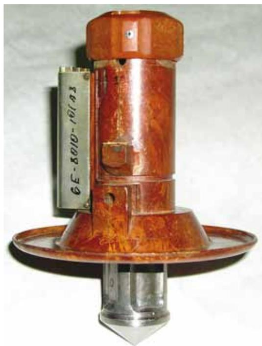
рисунок 2. Фотография узла системы сброса амортизации станции
