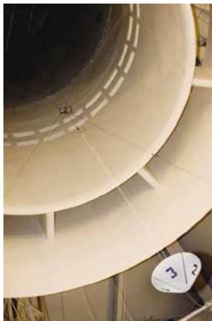
**рисунок 3.** Испытания полномасштабного макета СА «Фобос-Грунт» в вертикальной аэродинамической трубе Т-105 ЦАГИ
