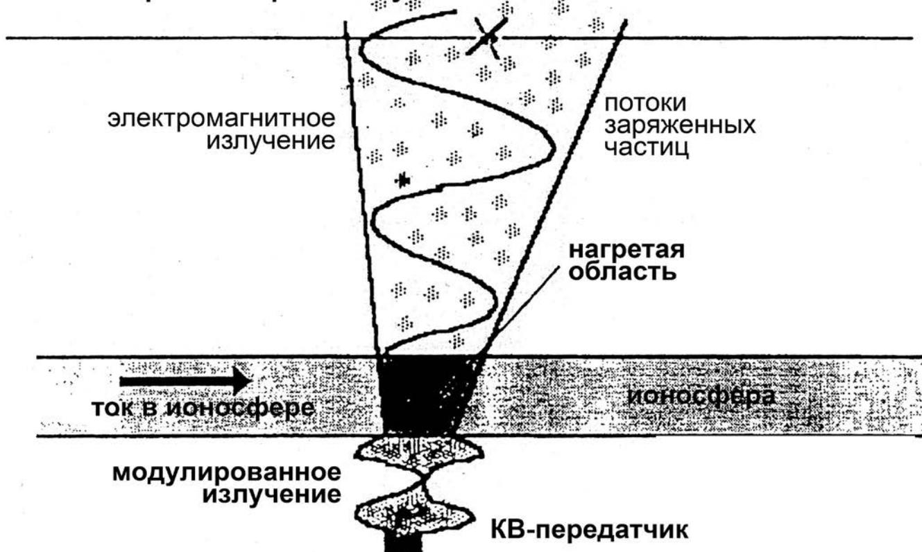
**рисунок 12.** Схема активного эксперимента по воздействию на магнитосферу мощного коротковолнового излучения с Земли
