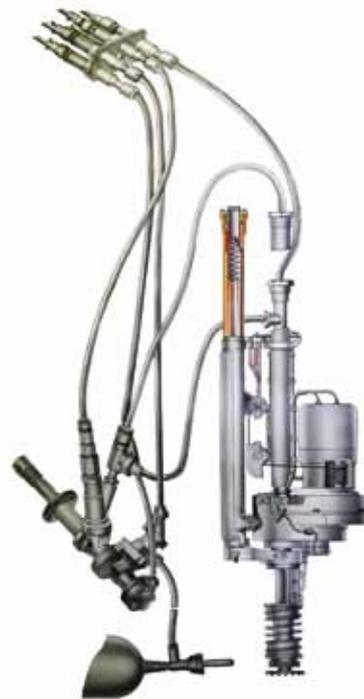
**рисунок 9.** Общий вид грунтозаборного устройства ВБ-02
