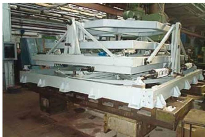
**рисунок 7.** Стенд ЦАГИ для высокоточного определения массы, положения центра масс и моментов инерции КА
