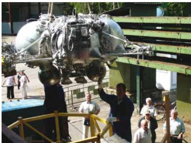
**рисунок 1.** Установка ДУ на стенд
