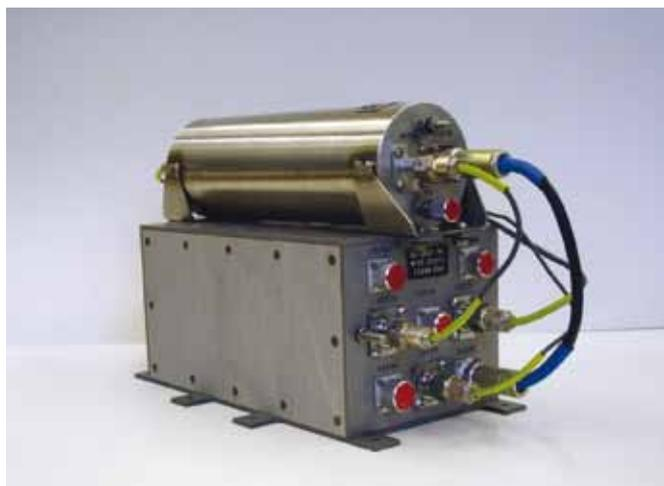
**рисунок 2.** Масс-спектрометр МАЛ-1Ф
