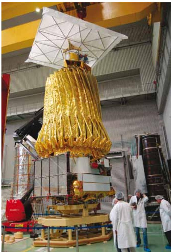
**рисунок 12.** Предпусковые наземные испытания КА «Спектр-Р»
