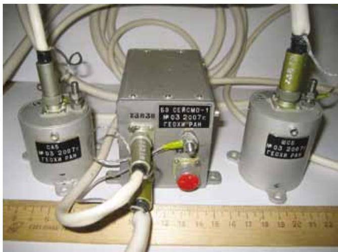
**рисунок 4.** Сейсмометр СЕЙСМО-1
