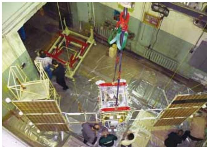
**рисунок 4.** ДИ КА «Канопус-В», обезвешенный во время испытаний эффективности гасителей колебаний БФ
