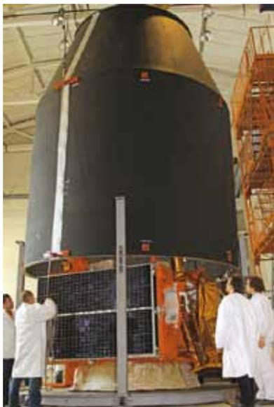
**рисунок 6.** Подготовка КА «Экспресс МД-2» к этапу приемосдаточных испытаний в реверберационной камере РК-1500 ЦАГИ
