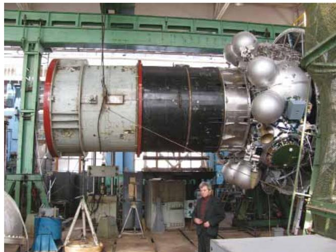
**рисунок 5.** Фрагмент испытаний сборки с РБ «Фрегат» и переходным отсеком «ПХО» на расчетный случай транспортирования
