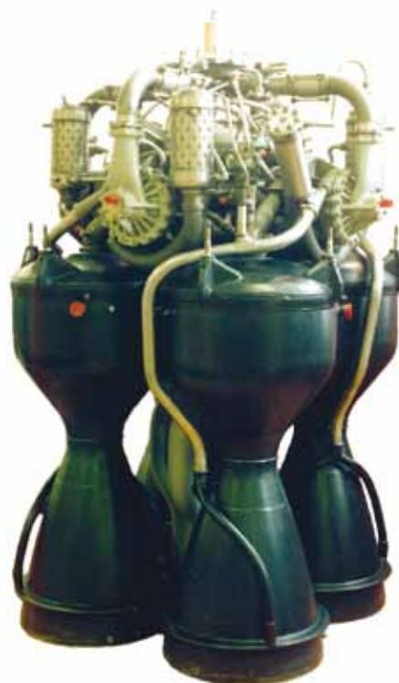
**рисунок 2.** Двигатель С2.1100 разработки А.М. Исаева для МКР «Буря» разработки С.А. Лавочкина
