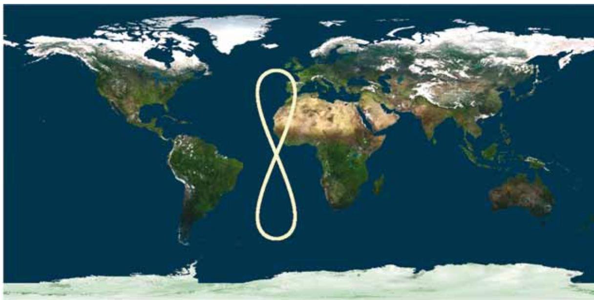
рисунок 5. Трасса подспутниковой точки на поверхности Земли
