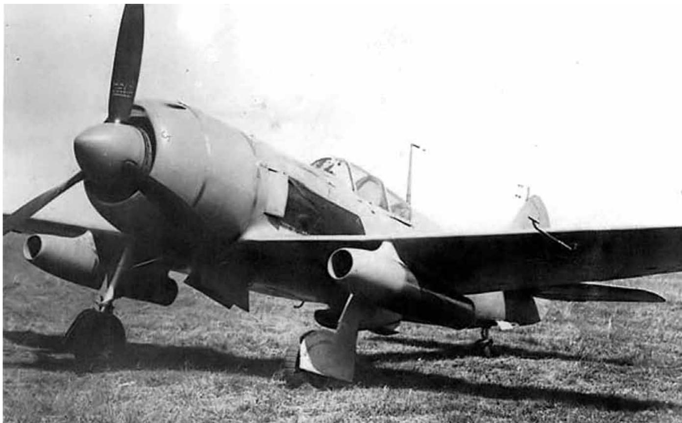
**рисунок 2.** Истребитель Ла-138 с ПВРД разработки НИИ-1
