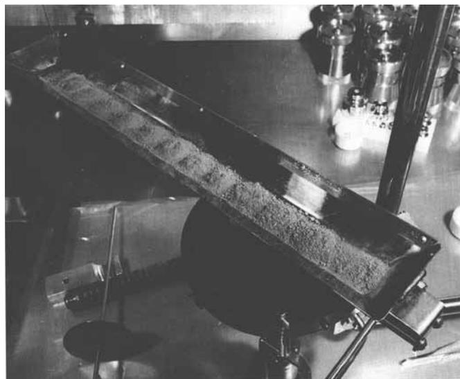
**рисунок 1.** Реголит, доставленный автоматической станцией «Луна-20», на лотке в приемной камере
