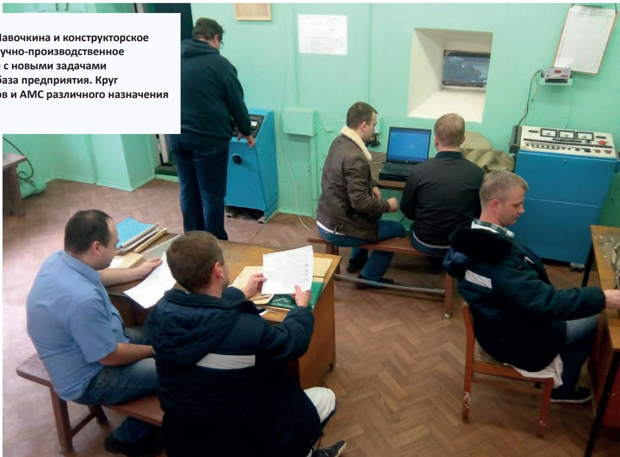
Общий вид пультовой стендов ускорений СУ-45 и СУ-267. Сотрудники отделов 573 и 575 вместе с представителями цеха 312 при проведении испытаний на центрифуге СУ-45 образца вентилятора для МОКБ «Фрегат».
