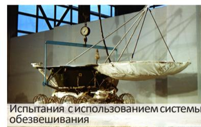
Испытания с использованием системы обезвешивания
