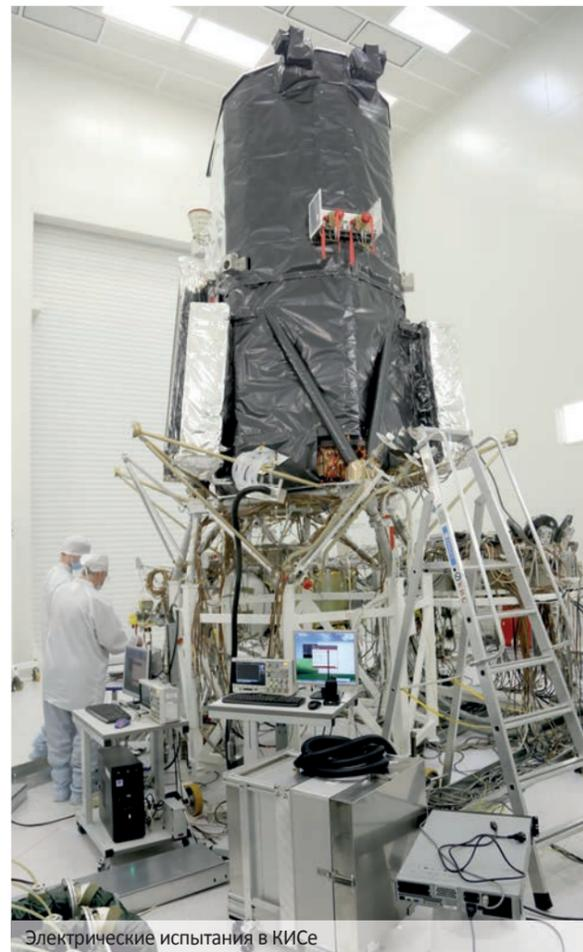
Электрические испытания в КИСе
