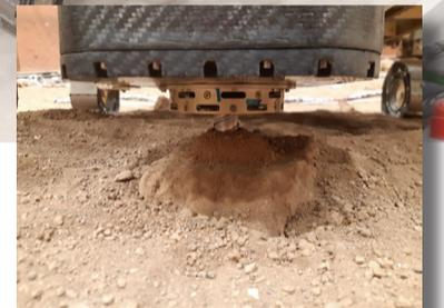
установка выводит образец на поверхность и доставляет его в лабораторию внутри ровера. Там он измельчается до порошка и распределяется по печам и контейнерам, предназначенным для проведения научных исследований на Марсе.
