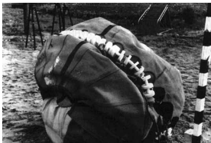
рисунок 3. Макет ТДУ и баллон-амортизатор АИС «Луна-9,-13» на имитаторе лунного грунта
