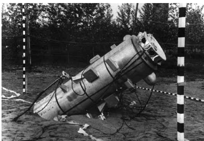
рисунок 3. Макет ТДУ и баллон-амортизатор АИС «Луна-9,-13» на имитаторе лунного грунта
