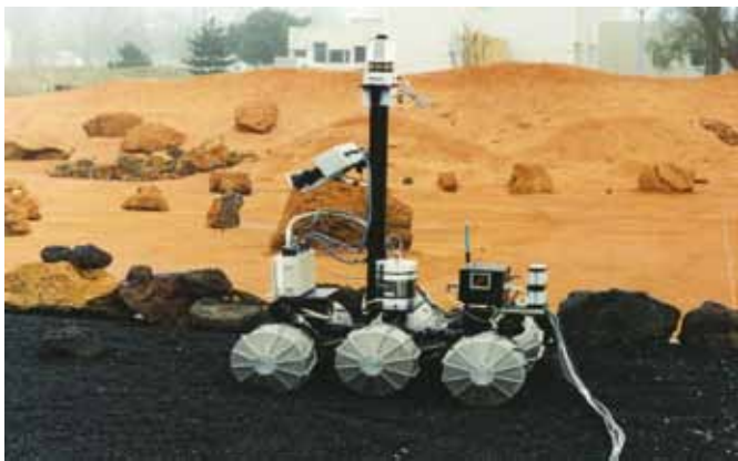
рисунок 4. Установка французской САТЗ на российском марсоходе НПО им. С.А. Лавочкина, шасси ВНИИТрансмаш. Планетодром «Жером» в Тулузе. Декабрь 1994 года
