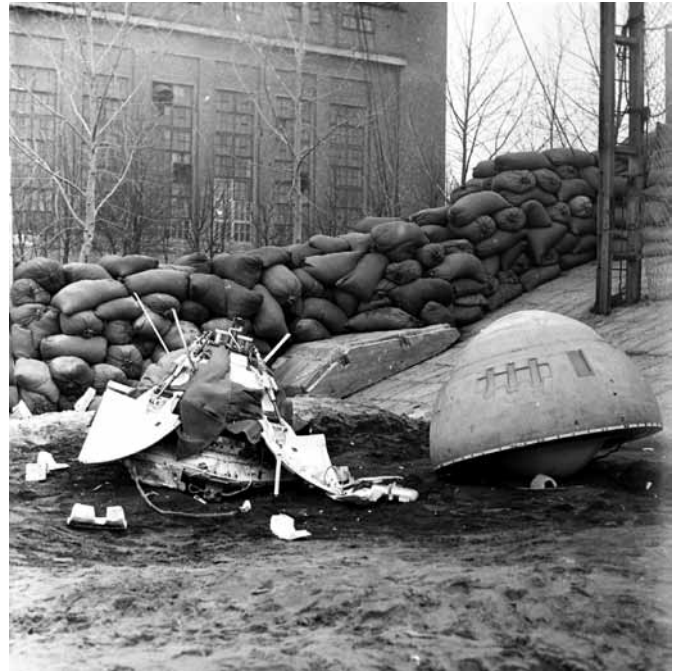
рисунок 5. Раскрытие створок макета АМС «Марс-6» после сброса с катапульты
