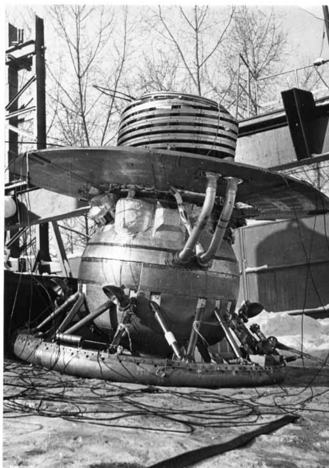
рисунок 8. ПА «Венера-9» после сброса на площадку-имитатор грунта
