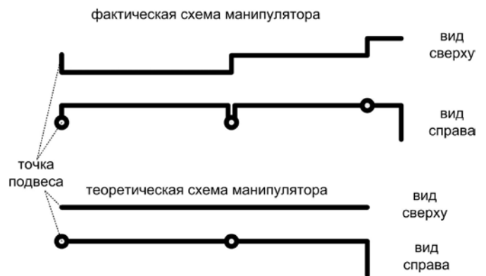
рисунок 4. Фактическая и теоретическая схемы манипулятора
