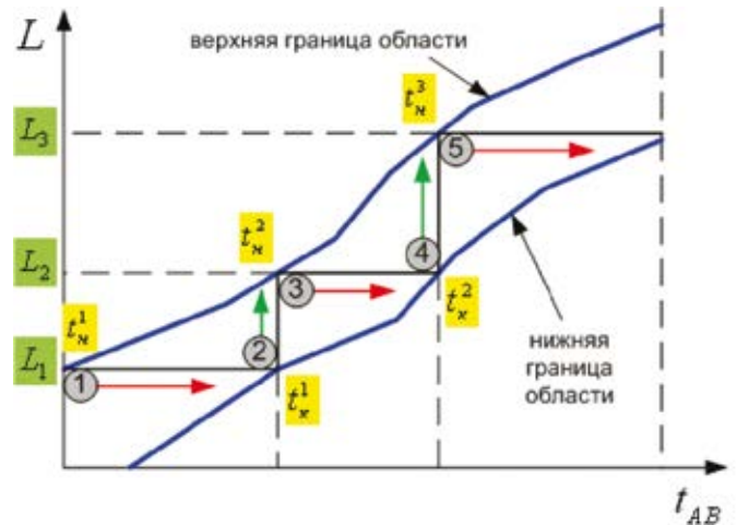
рисунк 5. Схема построения ломаной линии для определения параметров районов приведения
