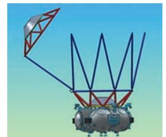
**рисунок 18.** Срабатывание пирочки включения торсиона. Начало закрытия фермы. Работа ДМТ для обеспечения ориентации
