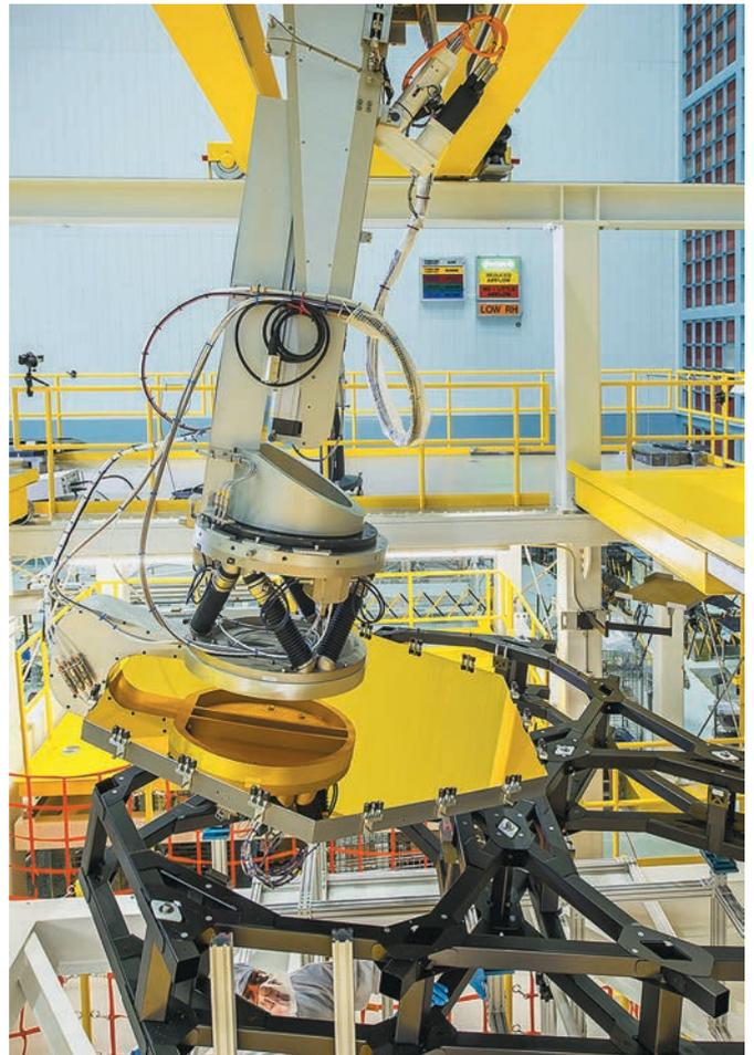
**рисунок 7.** Установка сегментов зеркала на каркас телескопа «ДЖЕЙМСА УЭББА»
