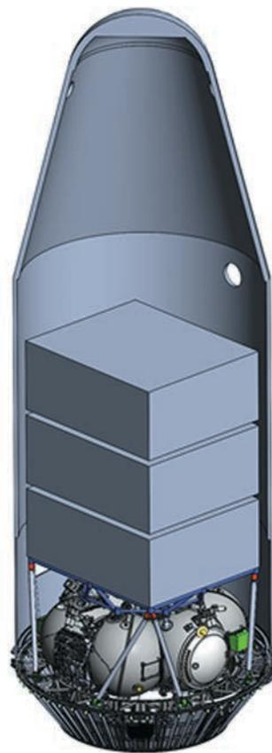
рисунок 7. Общий вид КГЧ с тремя спутниками
