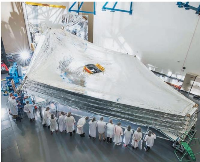
**рисунок 9.** Развёртываемый теплозащитный экран
