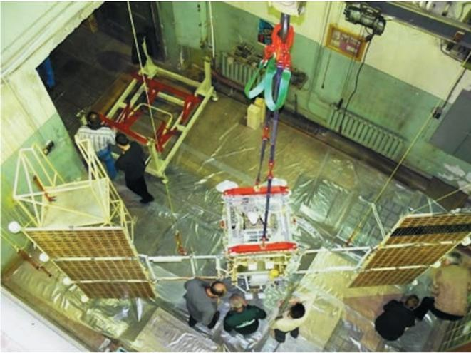
**рисунок 4.** ДИ КА «КАНОПУС-В», обезвешенный во время испытаний эффективности гасителей колебаний БФ
