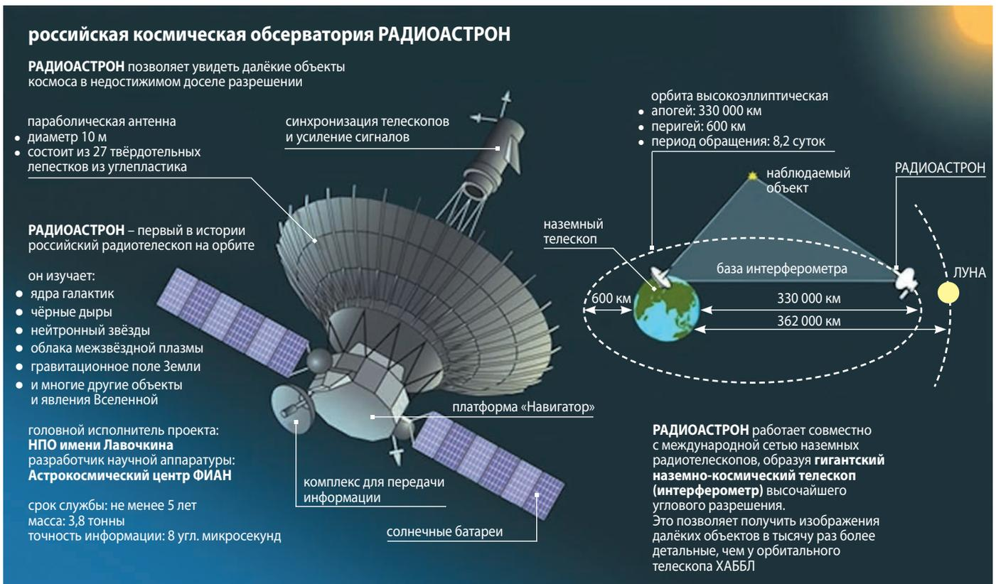
**рисунок 17.** Схема работы обсерватории «РАДИОАСТРОН»
