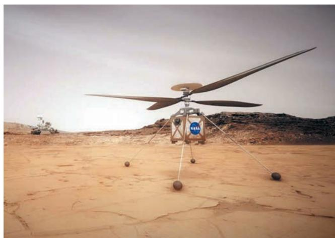
**рисунок 8.** Ingenuity – небольшой летающий дрон для тестирования технологии полётов на Марсе, вошёл в состав миссии NASA Марс-2020
