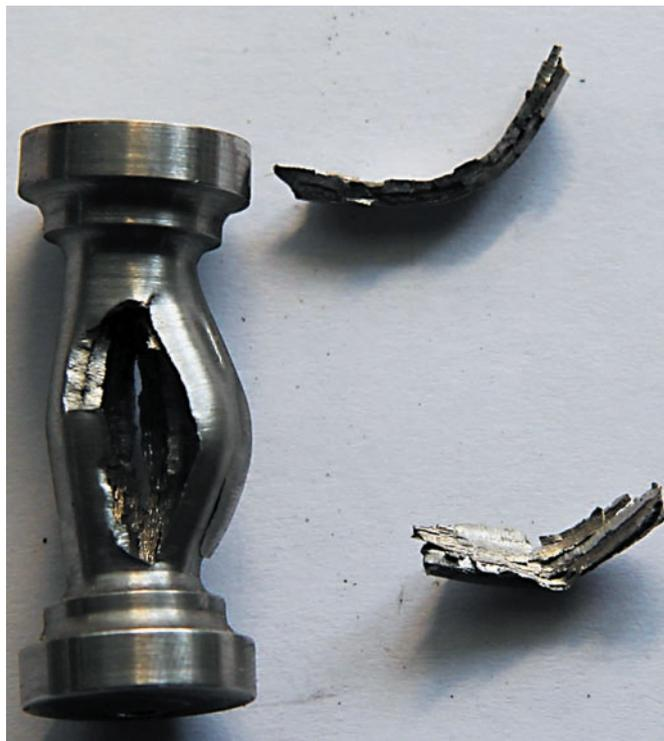
**рисунок 5.** Частичное разрушение МК
