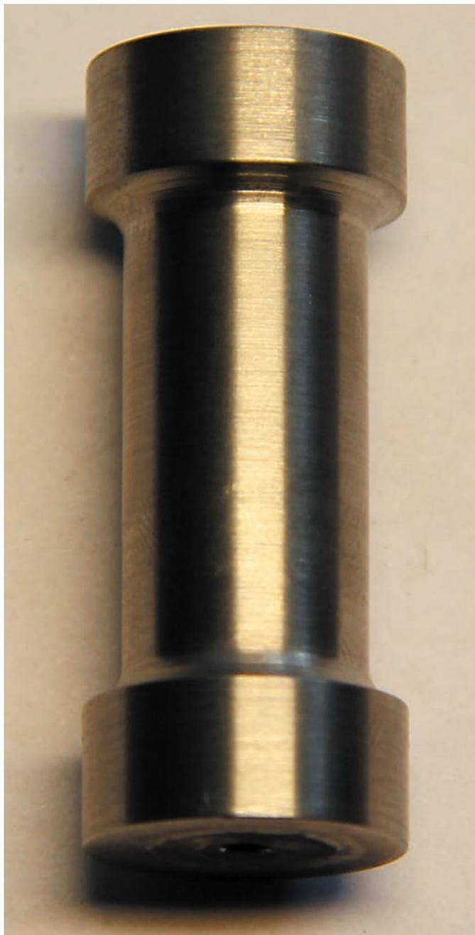
**рисунок 6.** Увеличение наружного диаметра МК без образования трещин
