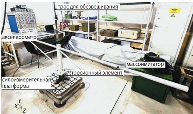
рисунок 2. Схема испытаний
