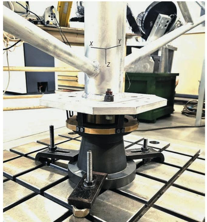
рисунок 4. Торсионный элемент
