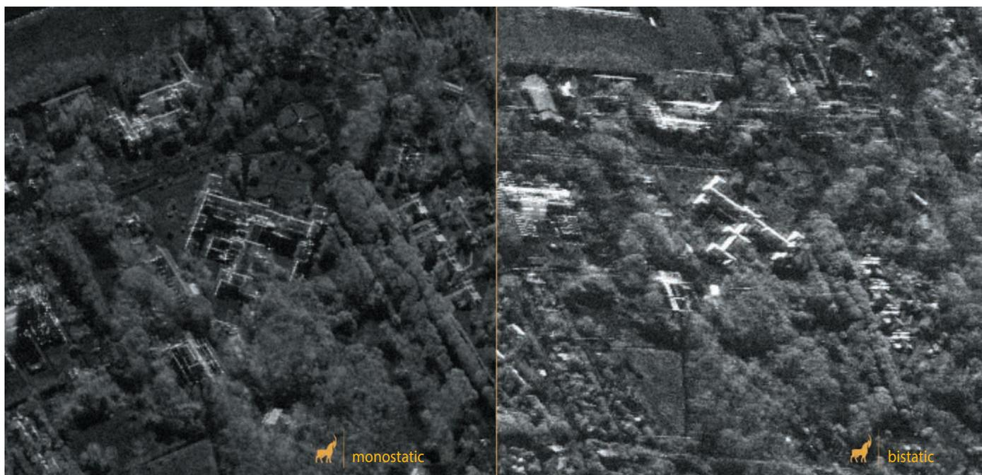
**рисунок 4.** Сравнение результатов радиолокационной съёмки в моностатическом и бистатическом режимах
