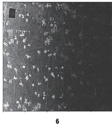
**рисунок 9.** Фрагмент изображения, в котором присутствует надирный эхосигнал (а) и результат его постпроцессорной обработки (б) (Петров А.С. и др., 2019)
