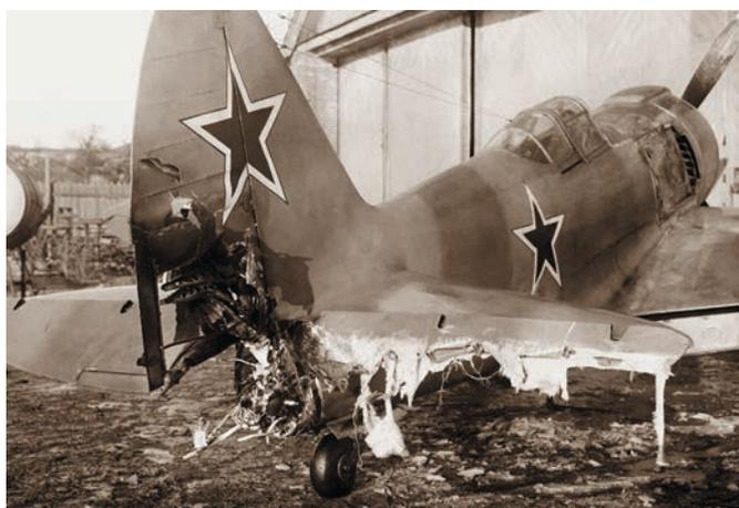
**рисунок 8.** Опытный истребитель Ла-7Р-2, повреждённый взрывом реактивного ускорителя РД-1 при испытаниях 27 марта 1945 года
