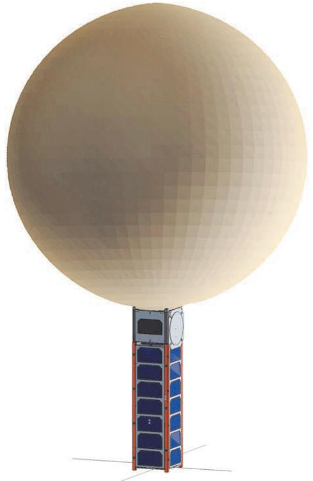
рисунок 8. Аэротормозное устройство в виде шара
