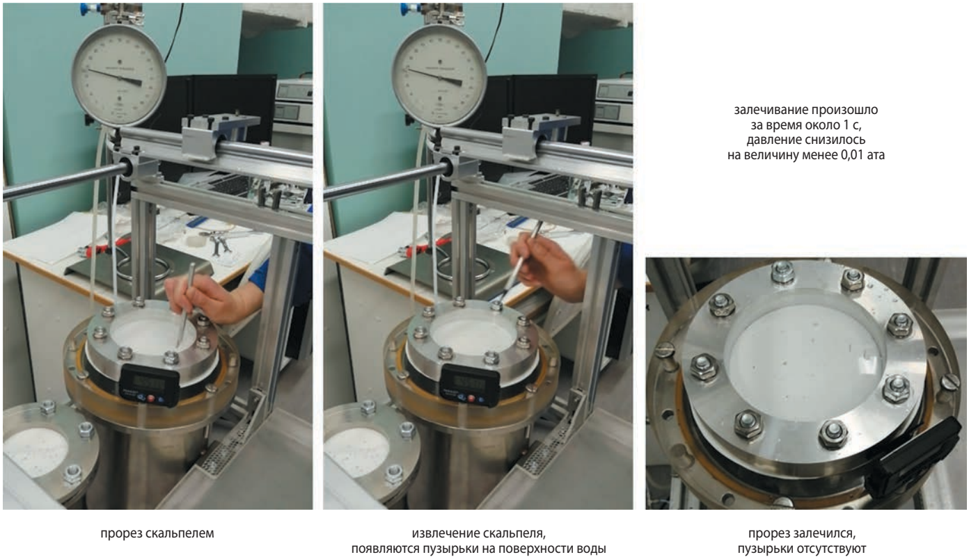
рисунок 9. Демонстрация залечивающих свойств макета слоистого композиционного материала при испытаниях на прорез (Залетова И.А., Ситников Н.Н., 2021)
