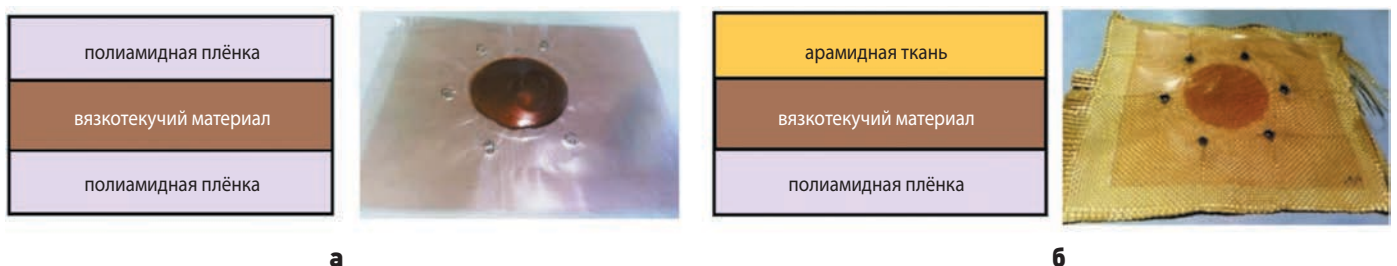
рисунок 7. Послойная конфигурация и общий вид композиций 1 (а) и 2 (б) самозалечивающегося слоистого композита (Pernigoni L., Grande A.M., 2020)
