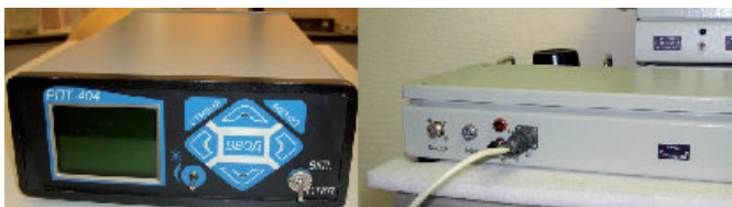
рисунок 8. Телеметрический приемник РПТ404 и контрольный передатчик ИТ403, работающие в диапазоне Д4
