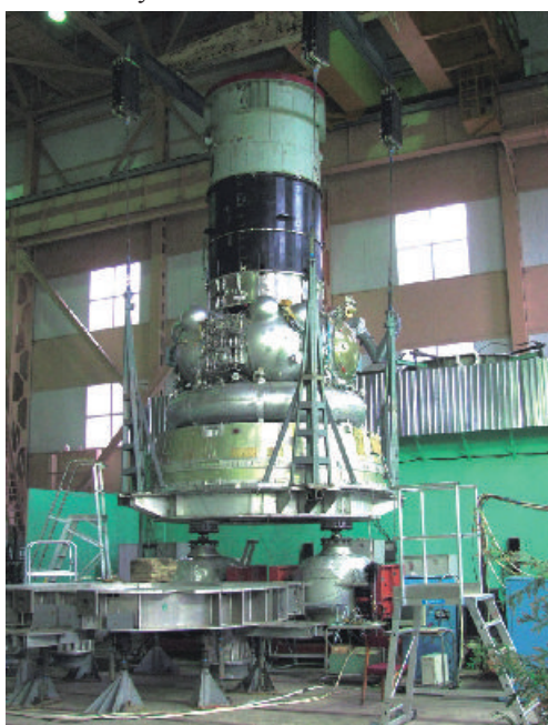
рисунок 19. Виброиспытания изделия с имитатором на виброкомплексе V984LDS на полетный случай в обеспечение запуска КА «Глобалстар-2»
