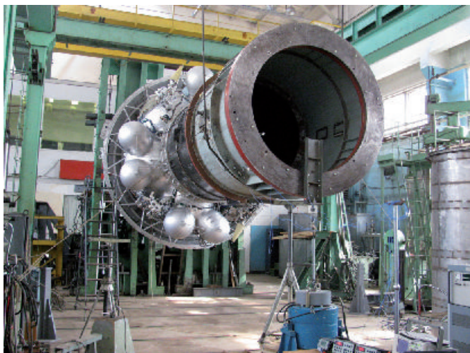
рисунок 20. Виброиспытания на случай консольного транспортирования КГЧ на ТК с использованием виброкомплекса ЭДСВ 300/100
