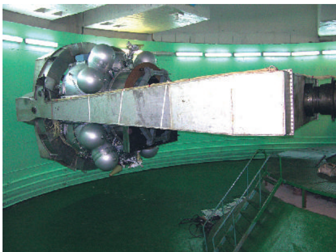
рисунок 18. Испытания изделия на центрифуге СУ-268 на случай действия максимальной продольной перегрузки в обеспечение запуска КА «Галилео-ИОВ»
