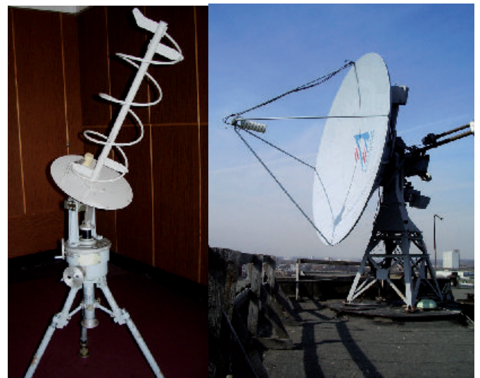
а – антенная система МТС; б – станция НС-3.7Л. рисунок 2. Антенные системы
