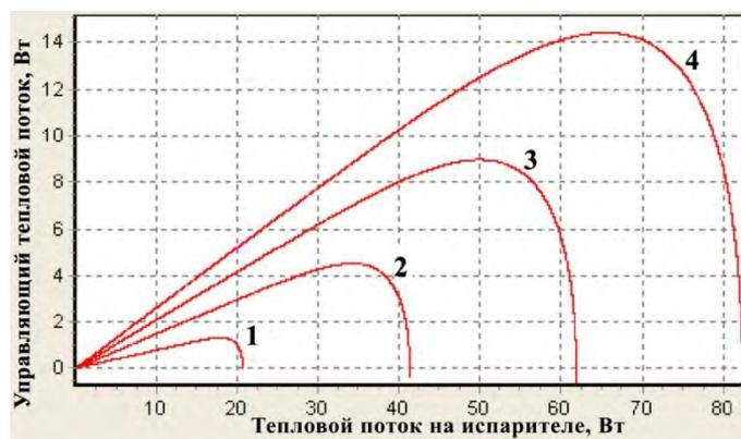
**Рисунок 4. Расчеты мощности для регулирования КнТТ с применением пакета EASY2.1**
