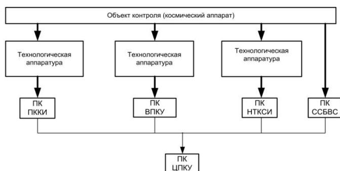
**ПК – персональный компьютер; ЦПКУ – центральный ПК управления; ПККИ – персональный компьютер команд и измерений; ВПКУ – вспомогательный ПК управления; НТКСИ – наземный технологический комплекс системы измерений; СС БВС – система связи с бортовой вычислительной системой.**
