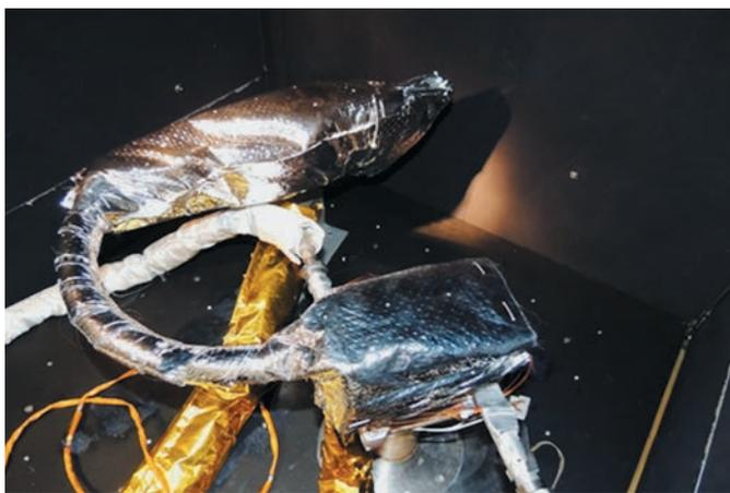
**рисунок 9.** Теплоизоляция фрагмента теплопровода ФПУ БКП, выполненная методом послойной спиральной намотки экранов ЭВТИ
