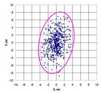
Рисунок 7. Эллипс рассеивания капсулы при радиусе трубки траекторий 3 км
