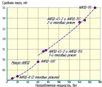
Рисунок 12. Зависимость средней тяги АИПД от потребляемой ЭРДУ мощности
