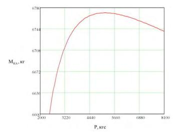
Рисунок 2. Зависимость полезной нагрузки М<sub>КА</sub> (кг) на целевой орбите от тяги Р (кгс) для РКН «Зенит-3SL»
