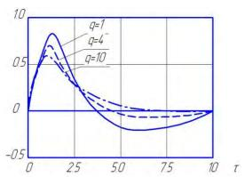
Рисунок 4. Расчетные осциллограммы разрядного тока *dφ/dt*
