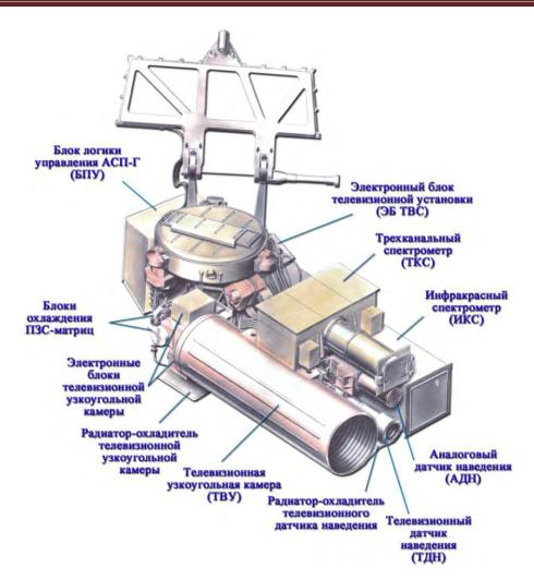
Рисунок 3. Автоматическая стабилизированная платформа
