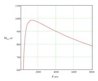
Рисунок 4. Зависимость полезной нагрузки М<sub>КА</sub> (кг) на целевой орбите от тяги Р (кгс) для РКН «Союз-2 этап 1б»
