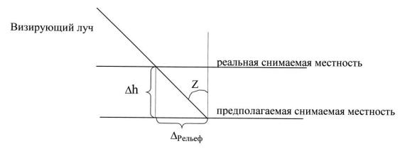
Рисунок 2. Ошибка привязки из-за погрешности знания высоты рельефа
