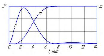
Рисунок 6. Динамика ввода мощности разряда  $J^2$  и массы m плазмообразующего вещества в разрядный канал АИПД
