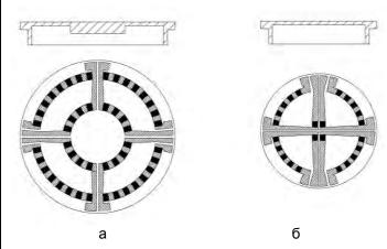
а – топология двухканальной измерительной схемы датчика давления на мембране с жестким центром; б
