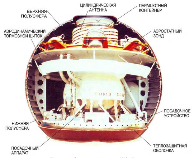
Рисунок 5. Спускаемый аппарат АМС «Вега»
