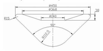
Рисунок 1. Форма спускаемой капсулы и еè геометрические размеры
