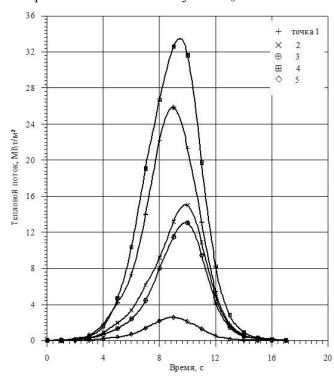
Рисунок 4. Суммарный тепловой поток в точках поверхности капсулы
