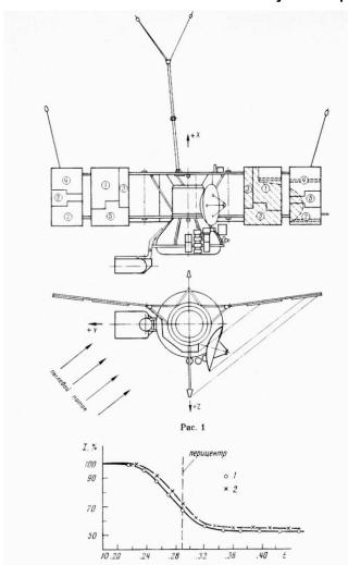
Рисунок 8. Воздействие пылевых частиц на СБ
