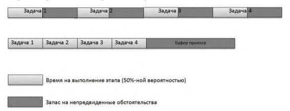
Рисунок 6. Буфер времени, помещенный в конец цепи, предохраняет ее от задержек по времени
