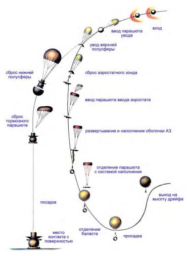
Рисунок 4. Схема спуска
