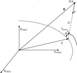
Рисунок 1. Определение геоцентрических координат точки снимка
