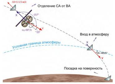
Рисунок 3. Схема автономного полета капсулы
