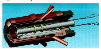
Рисунок 8. Чертèж водоохлаждаемой державки ТХУ с образцом ТЗП
