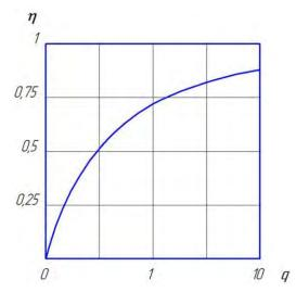
Рисунок 5. Зависимость электродинамического КПД  $\eta$  от параметра q
