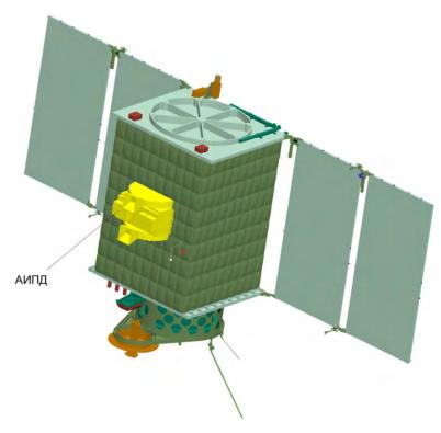
Рисунок 9. Микроспутник «Союз-Сат-О» с ЭРДУ на основе АИПД-155 (Меньшиков В.А., 2009)
