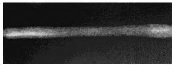
Рисунок 2. Рентгеновский снимок сварного шва с перьевыми кристаллами
