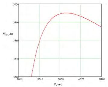
Рисунок 1. Зависимость полезной нагрузки М<sub>КА</sub> (кг) на целевой орбите от тяги Р (кгс) для РКН «Протон-М»
