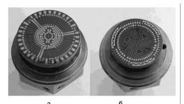
а – размещение TP, нормирующих и компенсационных элементов на мембране с жестким центром; б – размещение TP, нормирующих и компенсационных элементов на гладкой мембране.
