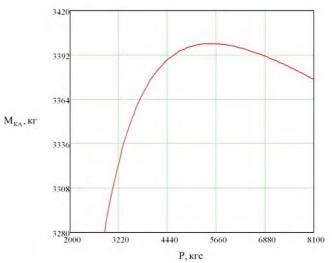
Рисунок 3. Зависимость полезной нагрузки M<sub>KA</sub> (кг) на целевой орбите от тяги P (кгс) для PKH «Ангара-А5»
