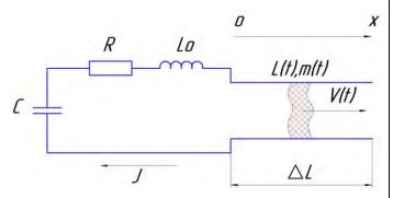
Рисунок 2. Принципиальная электрическая схема эквивалентной разрядной цепи АИПД
