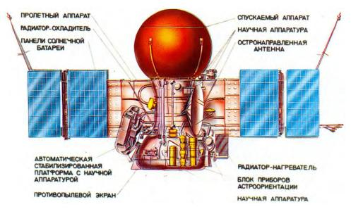
Рисунок 1. Космический аппарат «Вега»
