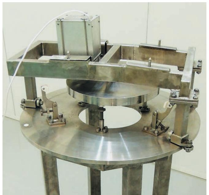
**рисунок 6.** Механизм перемещения шаровой установки для ВЗ
