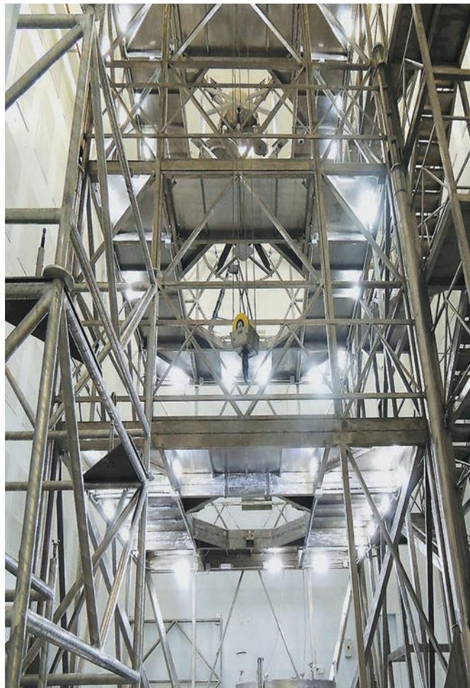
рисунок 3. Стенд сборки и юстировки телескопа Т-170М
