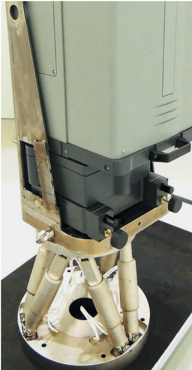
**рисунок 4.** Интерферометр на гексапode
