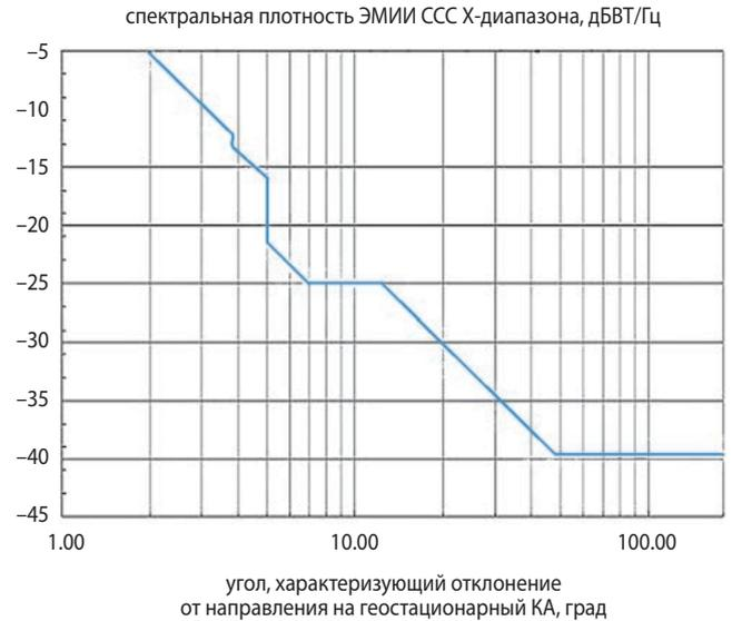
рисунки 2. График спектральной мощности ЭМИИ ССС X-диапазона
