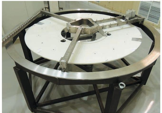
**рисунок 5.** Механизм перемещения шаровой установки для ГЗ
