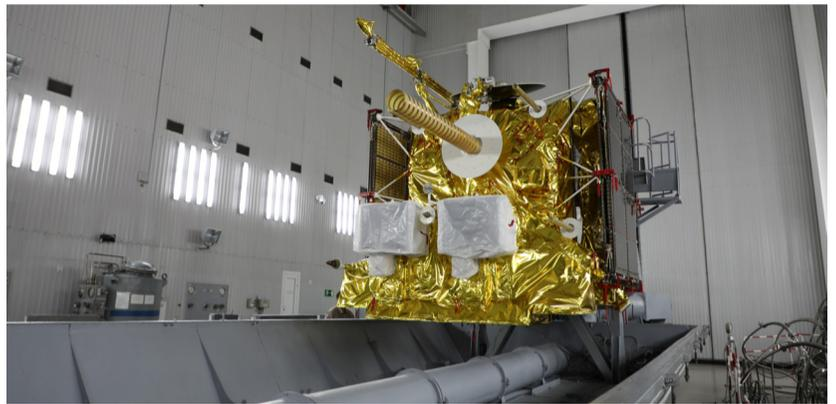
В конце января специалистами НПО Лавочкина обеспечена доставка на космодром Байконур габаритно-заправочного макета космического аппарата «ЭкзоМарс-2022». Макет предназначен для участия в испытаниях технического комплекса космического аппарата на космодроме, который обеспечит его подготовку к запуску в 2022 году.
